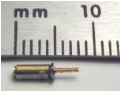
geliştirilen motorun resmi. Stator çapı 1,6 mm ve uzunluğu 4,0 mm.
