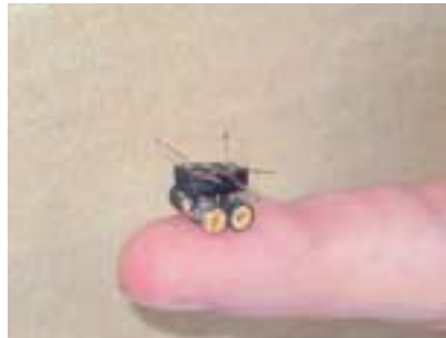
En uzun boyutu 10 mm'den daha küçük olan bir mikro robot mekanizması.
