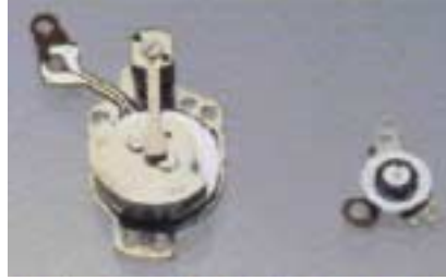
Seiko firması tarafından saat uygulamaları için geliştirilen mini motorlar
