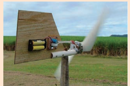
Şekil 17: Adım motorlu rüzgar jeneratörü
